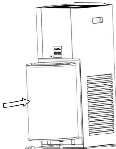
7> Verrouillez le filtre H13 : poussez le bloc de verrouillage du filtre vers l'avant comme indiqué ci-dessous
