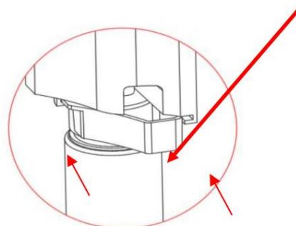
6> Chargez le nouveau filtre H13 : Placez le nouveau filtre H13 sur le plateau de verrouillage. (Remarque : il est nécessaire de placer le filtre avec la languette vers à l'utilisateur)
